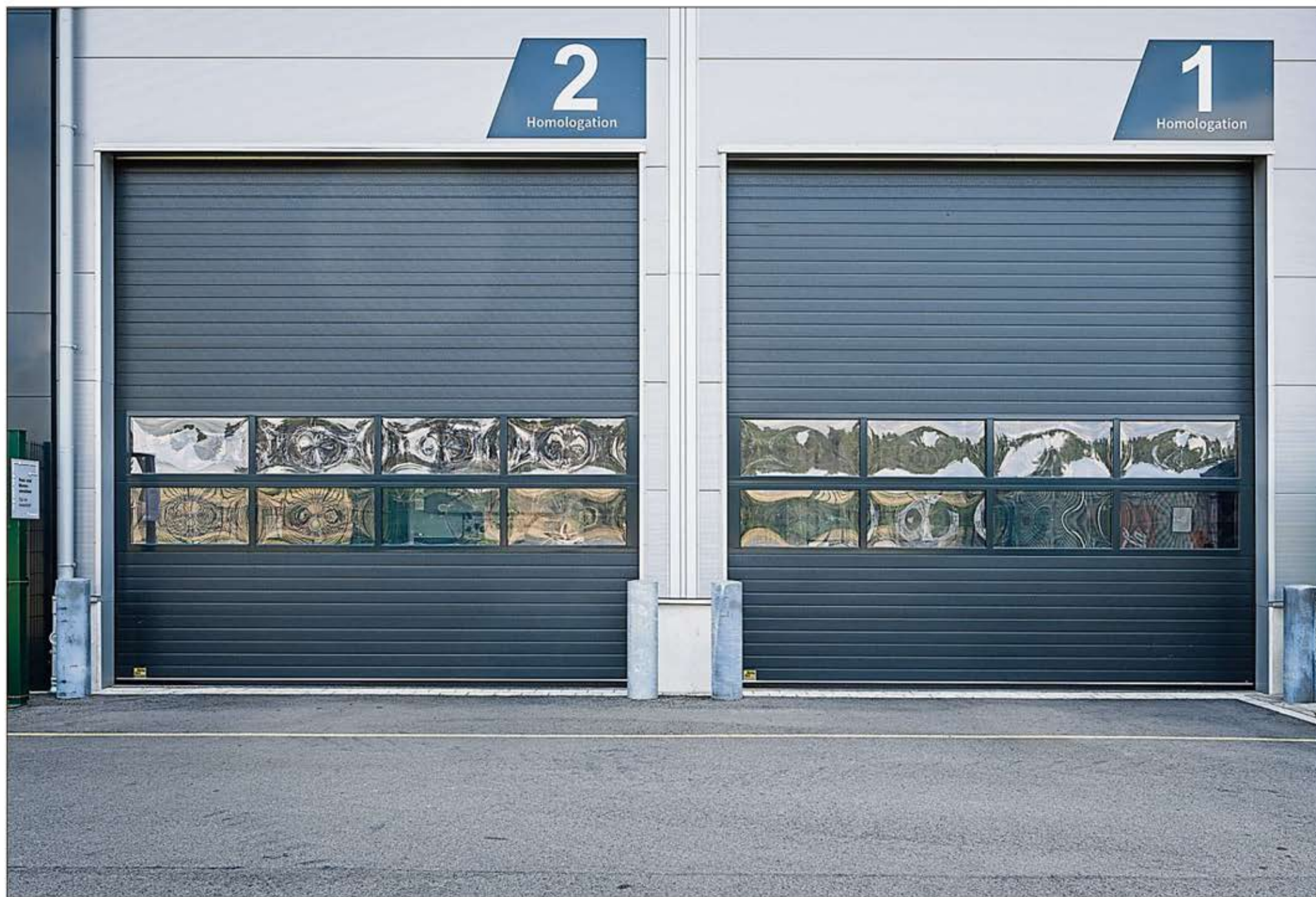
Die einzelnen Kassetten der Toranlagen sind mit Mineralwolle gefüllt, wodurch Schallschutzstärken von bis zu 42 Dezibel erreicht werden können.
